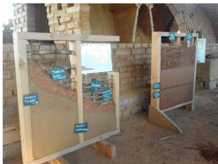
Maquettes torchis et terre allégée, formation TVRB 2022/23.
